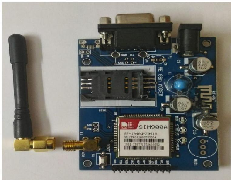
**Fig. 5 - GSM Module**
